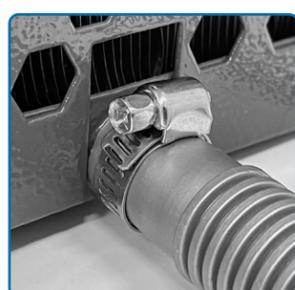
**2** Serrez le collier avec un tournevis à tête Philips pour sécuriser le tuyau en place et.
