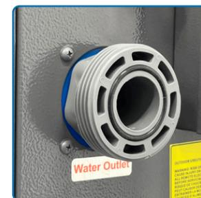
**2** Avant de commencer, assurez-vous que le joint 1 (schéma 12, E) et joint 2 (schéma 12, F) sont installés correctement sur le raccord de la pompe 1 (schéma 10, B). Installez le raccord de la pompe 1 dans la sortie d'eau comme montré sur le schéma.
