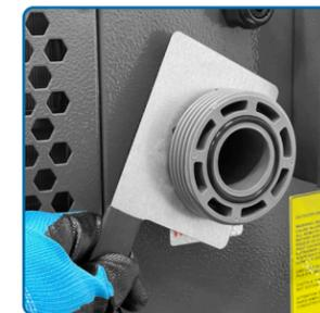
**3** Serrez le raccord de la pompe 1 avec la clé anglaise (schéma 12, G) comme montré sur le schéma. Protégez vos mains avec des gants.
