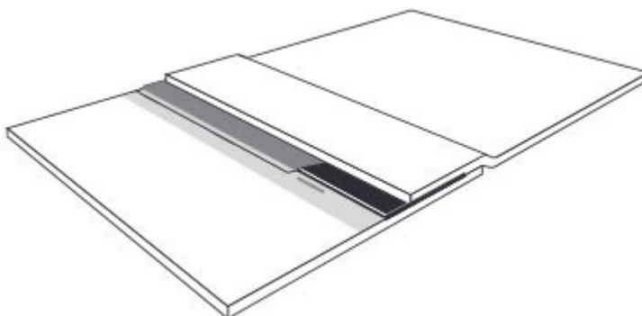
6. Décollez le papier de protection en le tirant du joint sous un angle de 90°. Tirez régulièrement le papier en le maintenant au raz de la membrane. Avec l'autre main, faite la jonction avec le plat de la main. Maroufler immédiatement la bande à l'aide d'une roulette afin de chasser l'air éventuellement retenu entre le primaire et la bande.
